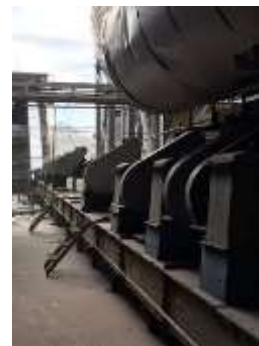
รูปที่ 23 เครื่องจักรที่มีการปิดครอบและแท่นวางเพื่อลดระดับเสียงและการสั่นสะเทือน
